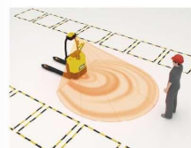
多重防撞保護 Multiple anti-collision protection
