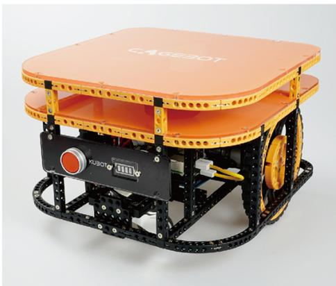
由祥儀企業【工業用AGV】研發團隊，以科技寶套件設計的KUBOT，是一款模擬AMR功能的自動智能搬運機器人，搭載工業級傳動機構，廣泛用於教學研究、企業運用等，如派車系統、智慧物流運輸等。
