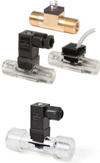
**VISION** 小型渦輪流量計是霍爾感應容積式流量計，其內部轉子藉由通過之流體力旋轉，該流體力與流量成正比。霍爾感測器檢測旋轉之轉子葉片並輸出脈衝信號 (K-factor)，此脈衝信號可用數位或類比信號處理器來處理。由於渦輪式轉子的質量很小，因而響應時間很快。
